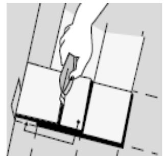
**Unebene Wände:** Manchmal muss die erste Reihe zugeschnitten werden, um die Unebenheit einer Wand auszugleichen. Übertragen Sie die Kontur der Wand auf die Dielen. Halten Sie einen Abstand von 5 mm (0,2") bis 10 mm (0,4") zur Wand für die Dehnungsfuge ein. Die Breite der ersten Dielenreihe sollte 5 cm oder mehr betragen.
