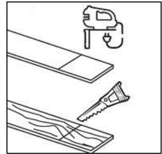
Stellen Sie sicher, dass die Längsseiten der Dielen geradlinig ausgerichtet sind. Verwenden Sie das abgeschnittene Stück Diele aus der vorherigen Reihe, um mit dem Verlegen der nächsten Reihe zu beginnen. Der Dielenversatz sollte stets mindestens 30 cm (12") oder 1/3 der Diele betragen. Falls das Reststück zu kurz sein sollte, verwenden Sie eine neue Diele und schneiden diese in der Mitte durch.
