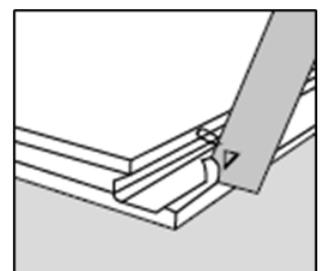
**Türrahmen:** Falls ein Türrahmen gekürzt werden muss, verwenden Sie zu Ermittlung der richtigen Länge ein Stück Diele.. Sägen Sie den Türrahmen und die Zierleiste auf die benötigte Höhe zu, wobei Sie 2 mm (0,08") Raum für die Dielen einrechnen sollten. Die Dielen können von allen Seiten aus gelegt werden. Dadurch wird es leichter, die Verlegung von Dielen z. B. an Türen zu planen.
