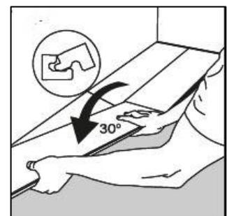
Heben Sie die Dielen (zusammen mit der vorherigen Diele in derselben Reihe) leicht an (ca. 30 mm (1.2" ) ), drücken Sie diese gegen die zuvor verlegte Reihe und dann nach unten. Tipp: Diese Bewegung macht leichte Anpassungen an dem Winkel, an dem die Diele angedrückt wird, erforderlich.
