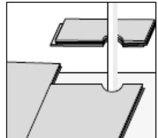
Schneiden Sie die Diele im 45°-Winkel zur Öffnung ab. Das ausgeschnittene Stück wird dann wieder in die Position geklebt. Bedecken Sie die Öffnung mit einer Rohrhülse
