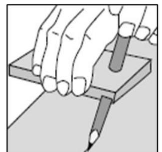
**(Verlegung an Türen und Heizungen und Verlegung von letzten Reihen).** Wenn Sie die Fliese nicht rechtwinklig unter dem Türrahmen oder einer in niedriger Höhe angebrachten Heizung verlegen können, schneiden Sie die Schließkante ab und tragen Sie Klebstoff (PVA D3 oder Isocyanat-Klebstoff) auf die Nut auf und bringen Sie die Diele in die richtige.
